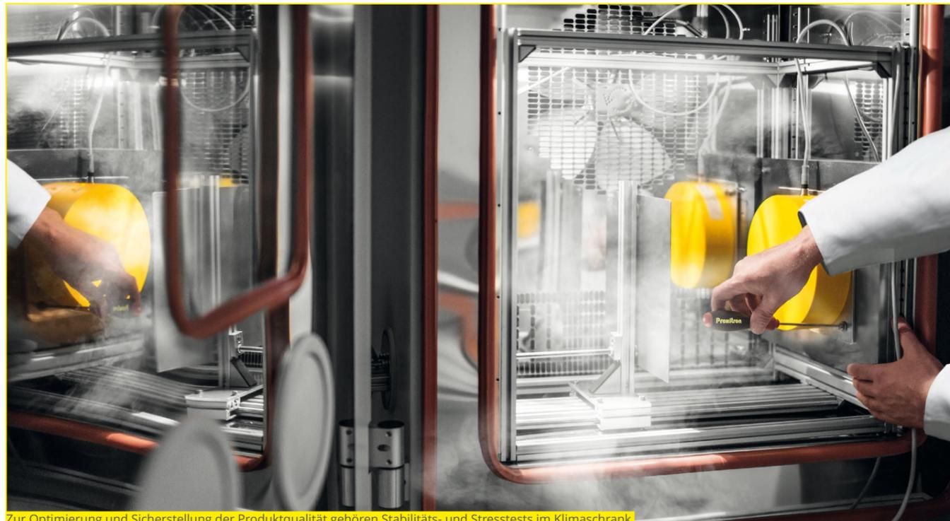
Zur Optimierung und Sicherstellung der Produktqualität gehören Stabilitäts- und Stresstests im Klimaschrank.
