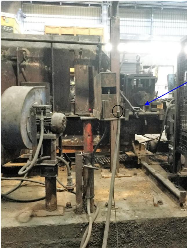
In diesem Metallbox hat Kunde neben der Schlingenkontrolle durch einen HMD Scanner einen LMB 100 platziert, sodass auch unser Laser Distanz Sensor durch die vorhandene Schlitzte auf das Material detektieren kann
