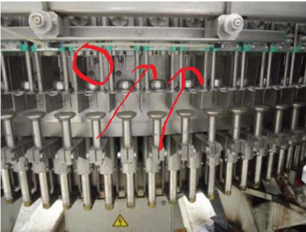
Die rot markierten Tüllen in der Rotationsfüllanlage können in die Flaschen fallen
