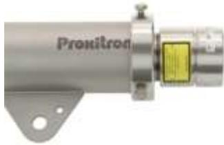
Mit dem optionalen LASER Pilotlicht Vorsatz DAK 308 und dem passenden Adapter (nicht im Lieferumfang enthalten) können PROXITRON Reflex Lichtschranken und PROXITRON Reflektoren exakt aufeinander ausgerichtet werden. Der Lichtpunkt des LASER Pilotlichtes visualisiert annähernd den Mittelpunkt der optischen Achse.
