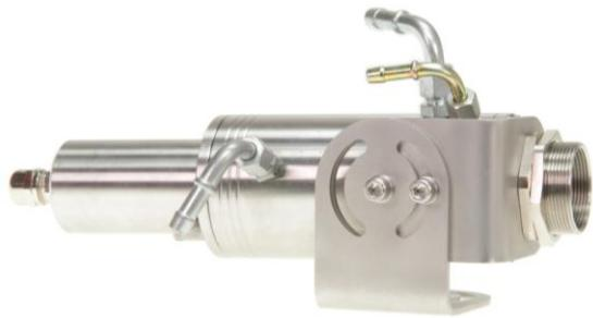
Entfernen Sie durch lösen der beiden M5 Schrauben den Deckel vom Kühlmantelgehäuse DAK 302 und stecken den Infrarot Sensor mit der Optikseite zuerst in das Kühlmantelgehäuse DAK 302. Jetzt das 8 polige Anschlusskabel mit dem S8 (M12 x 1 A) Stecker an den Infrasensor anschließen und den Deckel vom Kühlmantelgehäuse DAK 302 mit den beiden M5 Schrauben wieder befestigen. Wahlweise kann auch die als Zubehör erhältliche Kabelschutzkappe DAK 329 verwendet werden.
