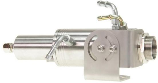
Entfernen Sie durch Lösen der beiden M5 Schrauben den Deckel vom Kühlmantelgehäuse DAK 302 und stecken den Infrarot Sensor mit der Optikseite zuerst in das Kühlmantelgehäuse DAK 302. Jetzt das 8-polige Anschlusskabel mit dem S8 (M12 x 1 A) Stecker an den Infrarotsensor anschließen und den Deckel vom Kühlmantelgehäuse DAK 302 mit den beiden M5 Schrauben wieder befestigen. Wahlweise kann auch die als Zubehör erhältliche Kabelschutzkappe DAK 329 verwendet werden.
