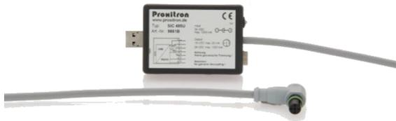
Der PIROS Infrarot Sensor benötigt zum Parametrieren eine Betriebsspannung von 24 V DC. Der Sensor kann entweder über den 8-poligen S8 Stecker mit Betriebsspannung versorgt werden oder die Versorgung kann auch mit dem Schnittstellenadapter SIC 485U zur Parametrierung erfolgen. Hierfür den Schnittstellenadapter mit dem Adapterkabel ST S8 S4/5-2 mit dem 8 poligen S8 Stecker des PIROS Infrarot-Sensor
