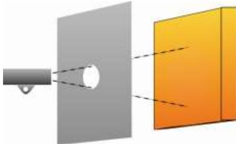
Zur Ausnutzung der vollen Sensorempfindlichkeit sollte diese Öffnung mindestens 50 mm Durchmesser haben. Bei einer Objekttemperatur, die deutlich oberhalb der Ansprechtemperatur des Sensors liegt, kann diese Öffnung kleiner gewählt werden, um den Schutz zu erhöhen.
