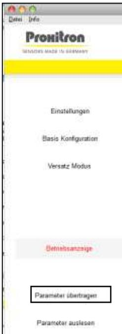
Mit Auswahl der Schaltfläche **Parameter übertragen** werden die aktuellen Einstellungen in der Software an den Sensor übertragen.
