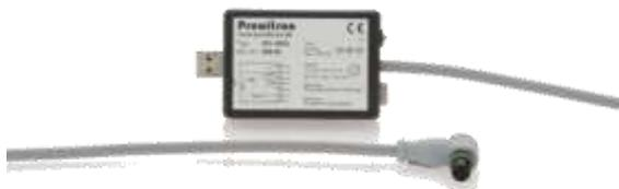
Der PIROS Infrarot Sensor benötigt zum Parametrieren eine Betriebsspannung von 24 V DC. Der Sensor kann entweder über den 5-poligen S4 Stecker mit Betriebsspannung versorgt werden oder die Versorgung kann auch mit dem Schnittstellenadapter SIC 485U S6 über den 4 poligen S6 Stecker zur Parametrierung erfolgen. Hierfür den Schnittstellenadapter mit dem 4 poligen S6 Stecker des PIROS Infrarot-Sensor und dem
