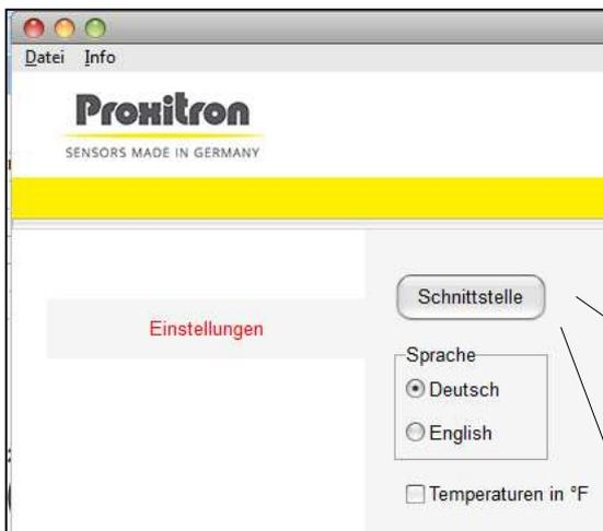
Die Einstellung des **COM-Ports** ist bei jedem Gerät unterschiedlich, wählen Sie die passende Schnittstelle aus. In der Regel wird Ihnen nur eine Schnittstelle angeboten. Eine Einstellung der **Baudrate**, **Parität** und des **Stop-Bits** muss in der Regel nicht vorgenommen werden. Benötigt wird folgende Einstellung:
