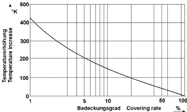
Entsprechend dem Grad der Bedeckung des Messfleckes durch das Objekt, muss dessen Temperatur höher als die Ansprechtemperatur sein, um eine Erfassung zu ermöglichen.
