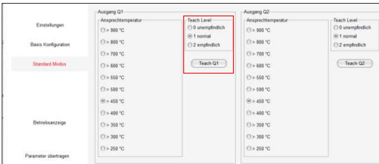
Mit den Schaltfläche **Teach Q1** und **Teach Q2** kann die Ansprechtemperatur automatisch auf die von dem PIROS Infrarot Sensor erkannte Objekttemperatur abgestimmt werden. Die nach dem Teach Vorgang eingestellte Ansprechtemperatur ist abhängig von dem eingestellten Teach-Level.
