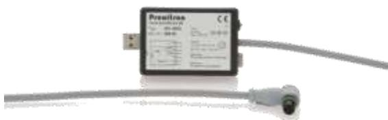
Der PIROS Infrarot Sensor benötigt zum Parametrieren eine Betriebsspannung von 24 V DC. Der Sensor kann entweder über den 5-poligen S4 Stecker mit Betriebsspannung versorgt werden oder die Versorgung kann auch mit dem Schnittstellenadapter SIC 485U S6 über den 4 poligen S6 Stecker zur Parametrierung erfolgen. Hierfür den Schnittstellenadapter mit dem 4 poligen S6 Stecker des PIROS Infrarot-Sensor und dem
