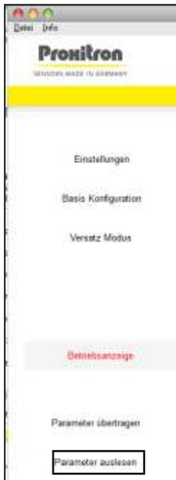
Mit Auswahl der Schaltfläche **Parameter auslesen**, werden die im angeschlossenen Sensor gespeicherten Einstellungen ausgelesen und in der Software angezeigt.
