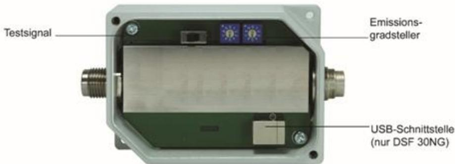
Emissionsgrad und Teststrom-Schalter
