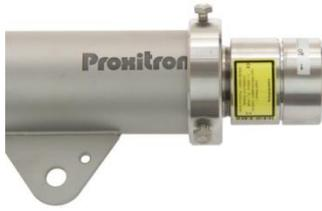
Die Ausrichthilfe der PROXITRON Lichtschranke ermöglicht eine exakte Ausrichtung. Die LED am Gerät visualisieren die empfangene Lichtmenge. Eine Grobausrichtung sollte zuerst nach Augenmaß oder mit Hilfe des Laserpointers DAK 308 erfolgen.
