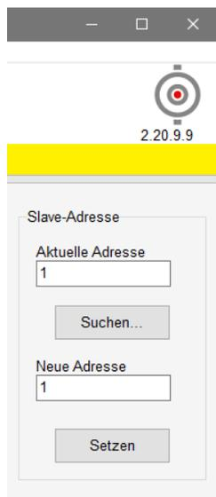
Durch die Slave-Adresse wird dem LMA/B eine eindeutige Adresse zugewiesen, um dem parallelen Betrieb von bis 253 Sensoren an einer RS-485 Schnittstelle zu ermöglichen. Bei Auslieferungszustand hat der LMA/B die: **aktuelle Adresse: 1**
