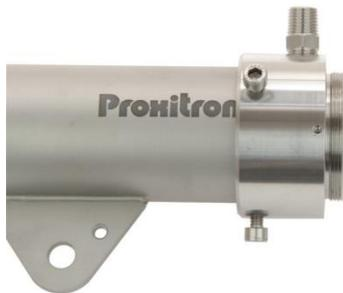
Zum Schutz der Optik vor Verschmutzung können PROXITRON Sensoren mit einem zusätzlichen Luftblasvorsatz versehen werden. Der empfohlene Betriebsdruck liegt bei 0,15 bar. Dieser Wert entspricht einem Verbrauch von 60 l/min. Der maximale Betriebsdruck liegt bei 0,3 bar. Um eine Verschmutzung der Optik durch Spülluft zu vermeiden, muss diese trocken, öl- und staubfrei sein. Für die optimale Wirkung des Luftblasvorsatzes wird der Einsatz eines zusätzlichen Tubus OL 46 empfohlen.
